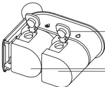
Bouchon de remplissage en silicone
